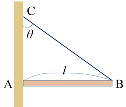
(1) 棒が受ける力を矢印で表してすべて図に書き込み、それぞれ適切な記号を付けよ(例えば、糸の張力  $T$ 、壁からの垂直抗力  $N$ 、壁からの静止摩擦力  $f$ 、重力  $Mg$  など、適切なものを用いよ)。ただし力の方向を正しく矢印で表すよう工夫すること。
